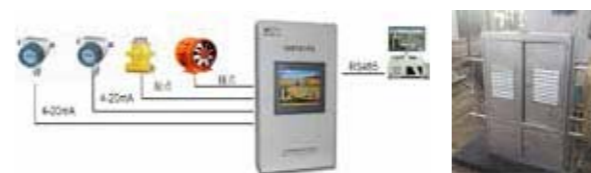
图4 在线气体检测装置
