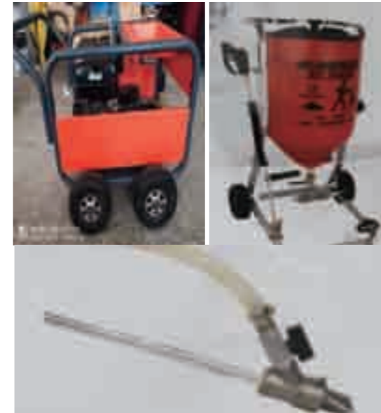
图10 高压水射流喷射改装机组
